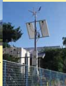
藤沢市川名に設置された「AI映像河川水位監視システム」(試験中)。
