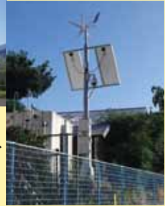
藤沢市川名に設置され た「AI映像河川水位監 視システム」(試験中)。
