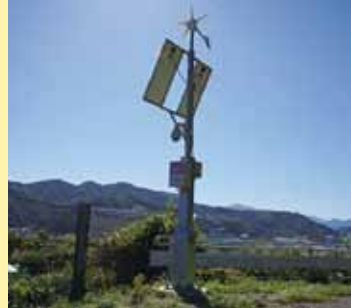
藤沢市川名に設置され た「AI映像河川水位監 視システム」(試験中)。
