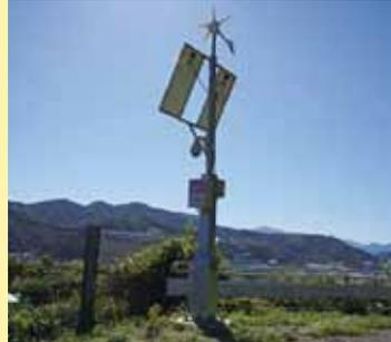
◀「岩手県釜石市復興ライブカメラ」。太陽光発電および風力発電機、蓄電にはリチウムイオン電池を利用している。
